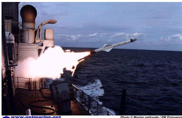
Tir d'un missile EXOCET du bord d'une frégate Française.
